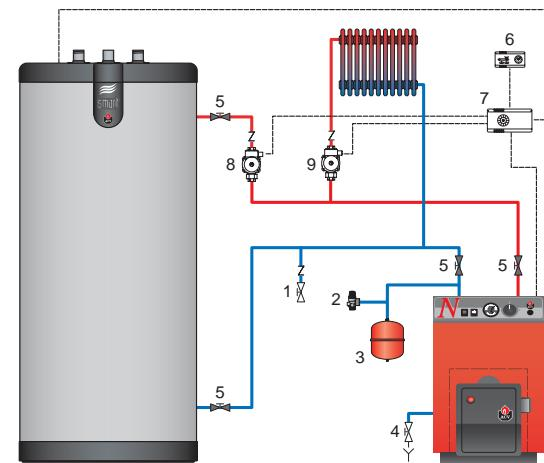
Схема с трехходовым клапаном **с** приводом.
