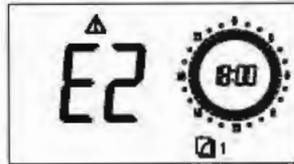
Решение: после остывания теплоносителя до 70°C перезапустите котел, нажмите кнопку RESET. Если котел не заработал, выключите его и свяжитесь со специалистом.
