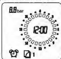
На табло все метки выключены (OF) и котел работает в режиме отопления с температурой теплоносителя на 20°C меньше заявленной.
